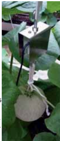
メロンの測定例。生体情報計測ノードで測定した平均葉枚数とLAI実測値が良い相関を示しました。LAI自動測定の可能性が示されました。
