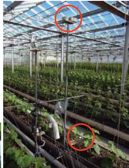
静岡マスクメロン生産者の温室への設置例。赤丸が、今回開発した可視光と赤外光を使って平均葉枚数を計測する低コスト光センサです。
