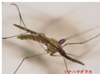
図5 虫体の固定方法 平滑な表面では珪砂で凹凸を作ってから接着する（左図） 有毛の体表では歯科用ワックスを熱で溶かしてすばやく接着させる（右図）
