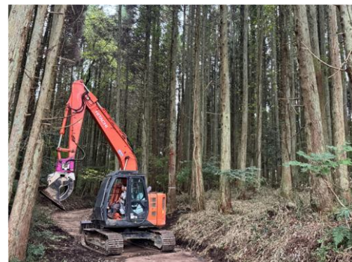
図-1 フェラーパンチャ機構付きバケットシステム
